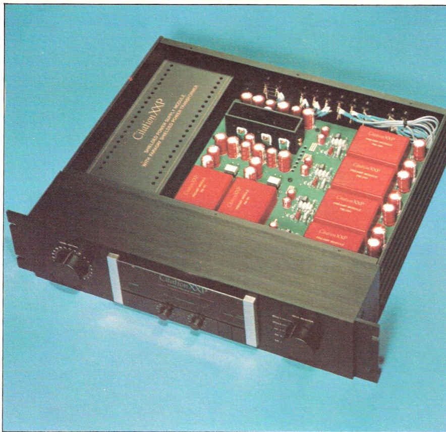
Capsule in resina proteggono i sei moduli che costituiscono il pre: due ampli di linea, quattro equalizzatori RIAA (per gli ingressi fono 1 e fono 2, di diversa sensibilità).
